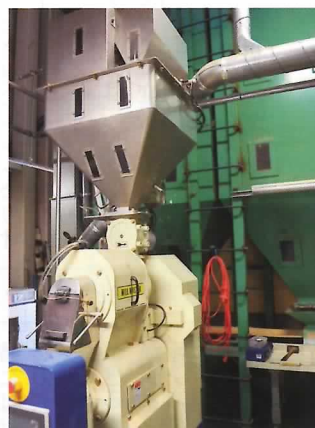
最大日産で約7ト、精米できる精米機＝松江市南田町
